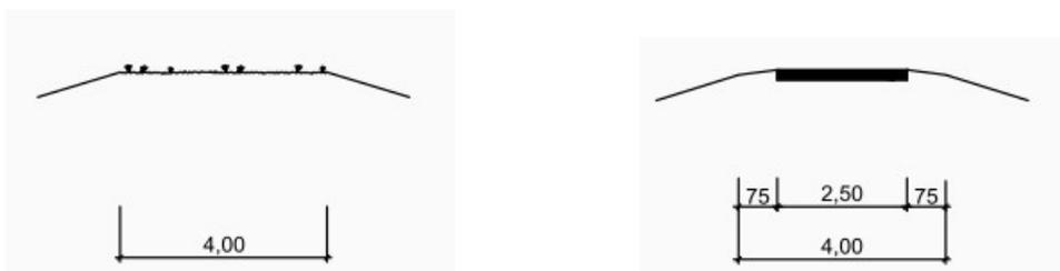
**Abbildung 15/16: Systemschnitte unbefestigter öFW Geh- Radweg**
